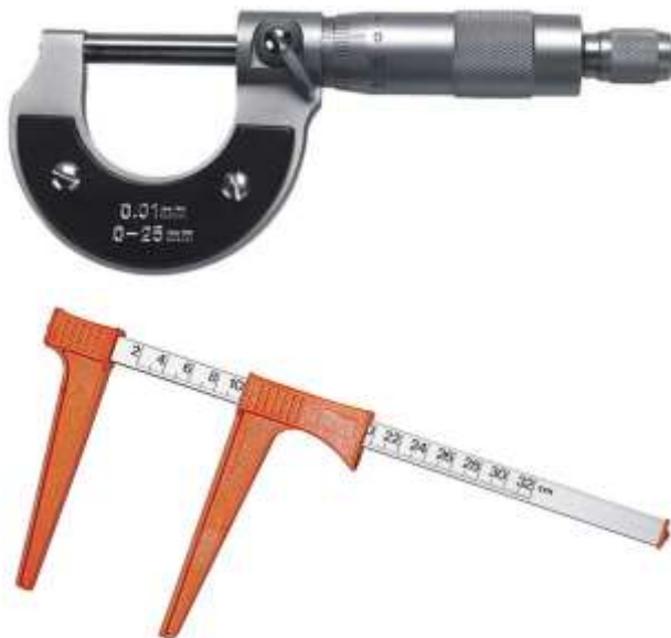
7. attēls. Mikrometrs 12 un dastmērs 13 .
